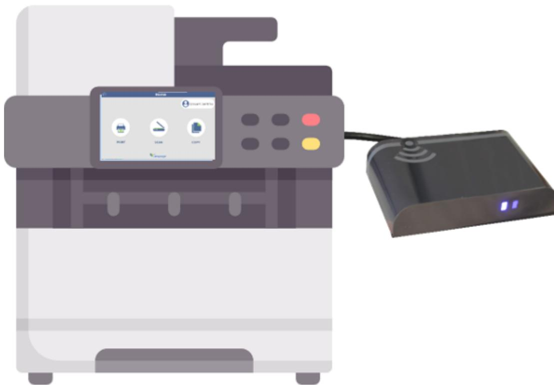
Los lectores de tarjetas contactless multifrecuencia de pequeño tamaño TCM4 de CARTADIS™ son compatibles con la mayoría de las tarjetas del mercado con tecnología de 13.56 MHz, 125 o 134.2 KHz. Por defecto, estos emulan a un teclado USB y por ello no requieren de un driver de Windows para instalarlos en un PC con Windows o un dispositivo MFP.
